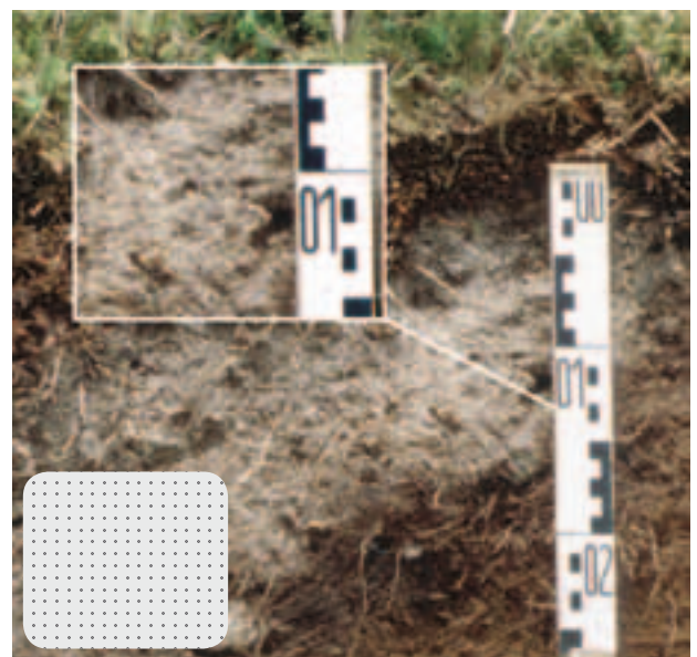
Abb. 15: E-Auswaschungshorizont, gebleicht (hellere Farbe), an Nährstoffen verarmt
