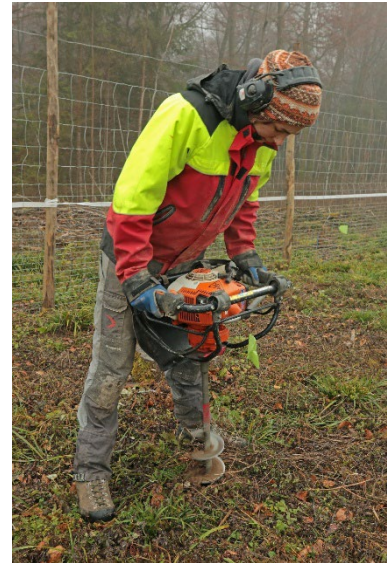
Abbildung 45: Grössere Motorbohrer können Löcher bis zu 30 cm Durchmesser bohren. (Foto: Ueli Wasem)
